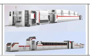
水性隔膜涂布设备、油性隔膜涂布设 备
